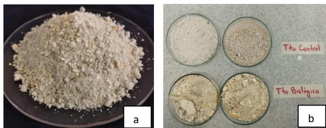
Figura 2. Cambios macroscópicos en la arena de sílice por MICP. a) arena sin tratamiento, b) arena control y arena con tratamiento biológico. Fuente propia
