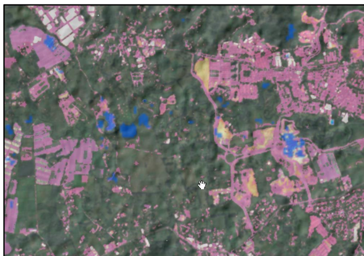
Figura 3. Zona de infraestructura detectada mediante clasificación no supervisada de imágenes Sentinel-2 (rosado) y manchas de máxima inundación (azul) según el Global Surface Water (GSW) de Pekel et al. (2016).
